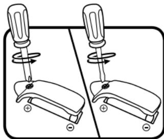
3. Insérer 1 pile LR6/AA en respectant le schéma qui se trouve dans le compartiment à pile. (Nous vous recommandons l'utilisation de piles alcalines neuves pour des performances optimales.)
