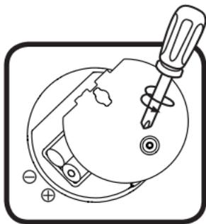
5. Refermer soigneusement le couvercle du compartiment à piles et s'assurer que la vis est bien serrée.
