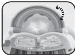
**Note** : si l'arc-en-ciel lumineux se détache, il suffit de le positionner dans la fente en forme de "T" sur un des côtés du nuage puis de l'insérer doucement de l'autre côté pour le fixer.
