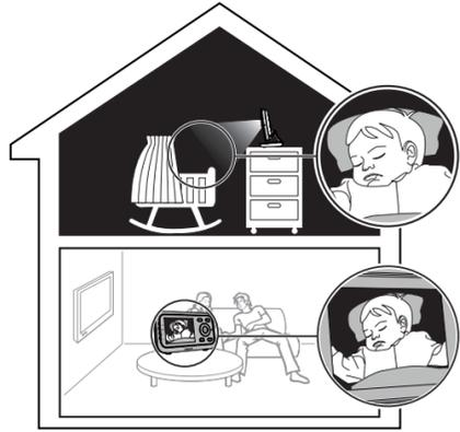
L'unité Bébé possède une caméra infrarouge qui s'active automatiquement lorsque l'intensité lumineuse de la pièce diminue. Elle permet de voir Bébé dans une pièce peu éclairée, ainsi que dans le noir total. Les images sont retransmises en noir et blanc sur l'écran de l'unité Parents et l'icône
