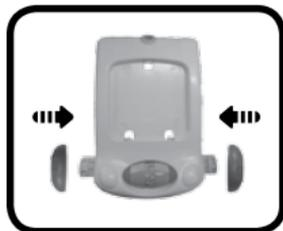
3. Introduzca las ruedas en sus huecos correspondientes en la parte de atras del andador. Deslice y mantenga el sistema de bloqueo cuando inserte las patas, asegurandose de estas quedan hacia fuera. Oira un clic cuando cada pata este correctamente colocada.
