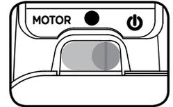
2. Im **Motor-Modus** stoppt der Motor automatisch nach 2 Sekunden, wenn er von den Schienen entfernt wird. Sobald sich der Zug wieder auf den Schienen befindet, wird der Motor reaktiviert.
