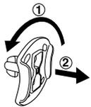
① Drehen Sie die Transportsicherung gegen den Uhrzeigersinn.
