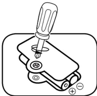
il est recommandé d'utiliser des piles alcalines ou des piles rechargeables Ni-MH pleinement rechargées.
