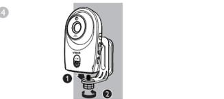
Placer l'unité Bébé sur le système de fixation afin que la vis puisse rentrer dans le trou situé sous la caméra. S'assurer que la vis est bien serrée.
