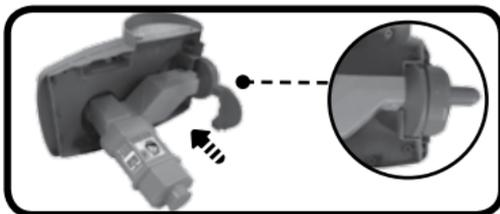
**B.** Una la pared a la base de la torre de control e inserte el soporte de la torre de control, como se muestra a continuación.
