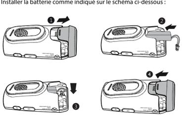
Pour changer la batterie, appuyer sur le couvercle du compartiment puis le retirer en suivant le sens de la flèche, puis tirer la batterie hors du compartiment à batterie. Suivre ensuite les étapes ci-dessus pour installer la batterie.
