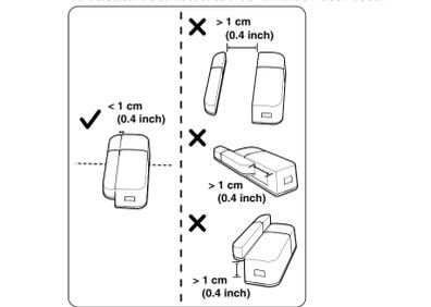
encadrement, ou si l'encadrement en raison de sa composition ou sa décoration ne permet pas de monter le détecteur et l'aimant au même niveau, il est possible d'utiliser un espaceur. Il est également possible de fixer l'aimant sur l'encadrement et le détecteur de contact directement sur la porte, la fenêtre ou le tiroir.
