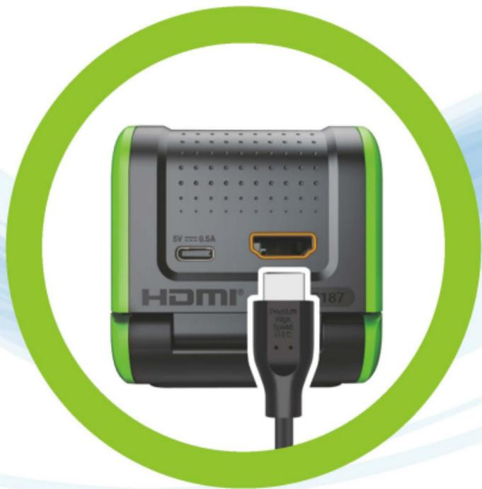
Insérer le **câble HDMI** à l'arrière de LeapMove®.
