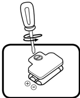
2. Ouvrir le compartiment à piles situé au dos de chaque pièce électronique à l'aide d'une pièce ou d'un tournevis.
