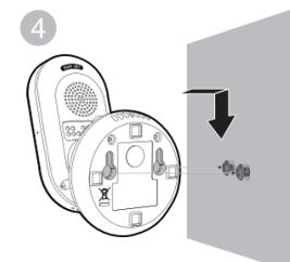
Alignez les œillets de montage au dos de l'unité Bébé avec les vis fixées au mur. Faites glisser l'unité Bébé vers le bas jusqu'à ce qu'elle se verrouille en place.
