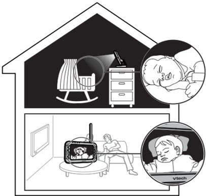
L'unité Bébé possède une caméra infrarouge qui s'active automatiquement lorsque l'intensité lumineuse de la pièce diminue. Elle permet de voir Bébé dans une pièce peu éclairée, ainsi que dans le noir total. Les images sont retransmises en noir et blanc sur l'écran de l'unité Parents et l'icône apparaît sur l'écran.
