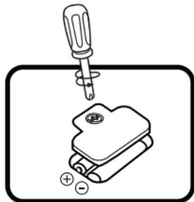
4. Insérer 2 piles LR6/AA en respectant le schéma qui se trouve dans le compartiment à piles. Pour de meilleures performances, il est recommandé d'utiliser des piles alcalines ou des piles rechargeables Ni-MH pleinement rechargées.
