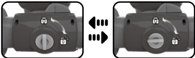
**Déverrouillage de la canne parentale :** appuyer sur le bouton de déverrouillage pour retirer la canne parentale.
