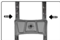
3. Insérer les **roues** de chaque côté de la tondeuse et appuyer fermement pour les assembler.
