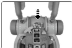
5. Assembler la **poignée** et la **tondeuse** en pressant fermement sur la poignée.
