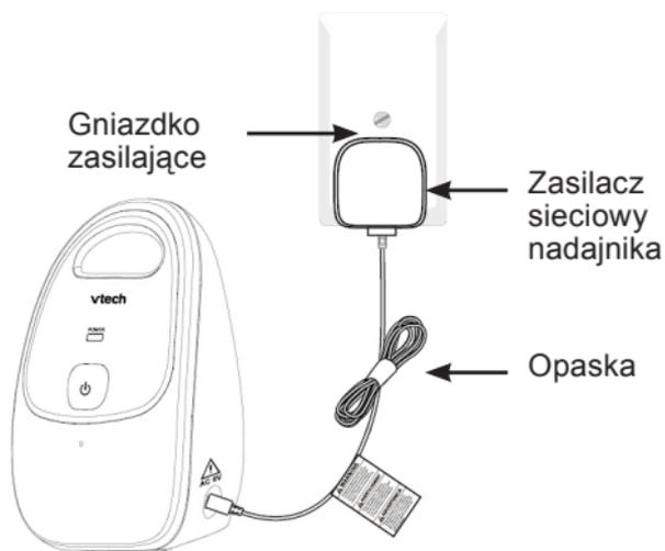
1. Użyj dowolnego z zasilaczy fabrycznie załączonych do niani. Włóż wtyk zasilacza do gniazda zasilania prądem stałym (DC) znajdującego się w boku obudowy nadajnika.
