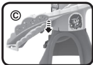
2. Verbinden Sie die Blätterplattform mit magischem Sensor (D) mit dem Ast (E). Befestigen Sie sie dann an der elektronischen Einheit. Sie hören ein Klick-Geräusch, wenn die Bauteile sicher miteinander verbunden sind. Stabilisieren Sie die Verbindung mit den Schrauben. Einmal aufgebaut, können die Teile nicht mehr auseinander genommen werden.
