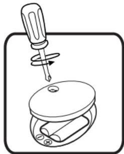
3. Insérer 2 piles LR6/AA en respectant le schéma qui se trouve dans le compartiment à piles.
