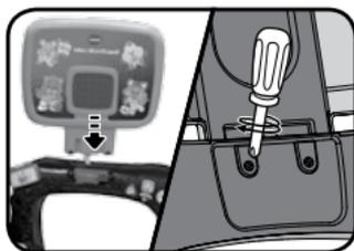
2. Insérer le **support** du **panneau** dans les emplacements correspondants de la **base** jusqu'à entendre un bruit sec. Retourner le tout et fixer le **support** à sa **base** en vissant 4 vis à l'aide d'un tournevis.
