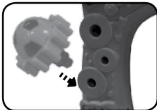
5. Sur le **support**, insérer le **panier** dans l'emplacement prévu à cet effet jusqu'à entendre un bruit sec.
