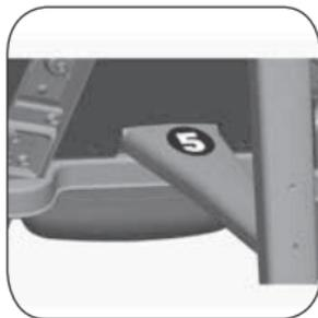
11. Clipser fermement l'autre partie du **renfort (5)** dans l'encoche jaune à l'intérieur de la **partie haute du pied arrière** comme montré ci-contre. (ATTENTION : une fois insérée, cette pièce ne peut plus être retirée.)
