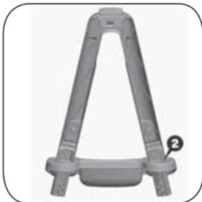
6. Utiliser **3 vis** et votre tournevis cruciforme pour assembler les éléments.
