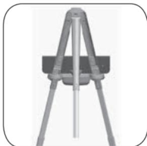
16. Fixer la **partie basse du pied arrière** à la **partie haute du pied arrière** à l'aide de **2 écrous** et **2 boulons**.
