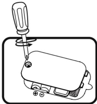
4. Setzen Sie 2 neue AA (AM-3/LR6) Batterien ein, wie auf dem Bild im Inneren des Batteriefaches dargestellt. (Für eine maximale Leistung wird das Verwenden neuer Batterien empfohlen.)
