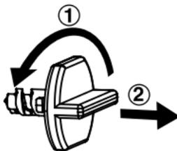
① Drehen Sie die Transportsicherung gegen den Uhrzeigersinn.
