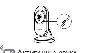
Se aprinde indicatorul luminos cu LED POWER pe unitatea pentru bebeluș.
